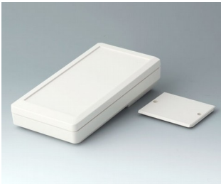
A9074107 DATEC-MOBIL-BOX M, Ausf. I ABS (UL 94 HB) grauweiß RAL 9002 195x101x44mm IP 65 opt.
