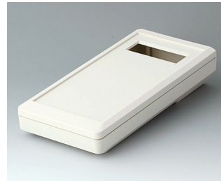
A9075217 DATEC-MOBIL-BOX L, Ausf. II ABS (UL 94 HB) grauweiß RAL 9002 252x121x50mm IP 65 opt.
