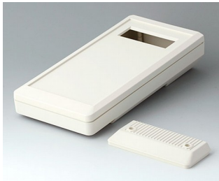
A9075207 DATEC-MOBIL-BOX L, Ausf. II ABS (UL 94 HB) grauweiß RAL 9002 252x121x50mm IP 65 opt.
