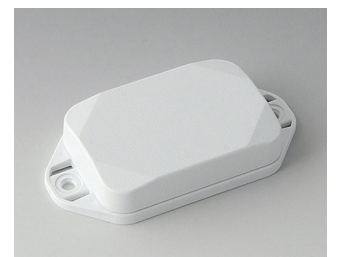
B1822127 MINI-DATA-BOX EF40, flach, mit Flansch ASA+PC (UL 94 V-0) verkehrsweiß RAL 9016 60x40x15mm IP 65 opt., IP 40
