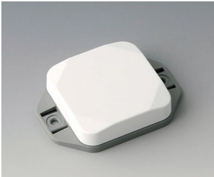
B1804126 MINI-DATA-BOX SF50, flach, mit Flansch ASA+PC (UL 94 V-0) verkehrsweiß RAL 9016 50x50x15mm IP 65 opt., IP 40
