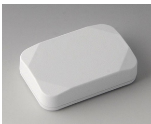
B1822117 MINI-DATA-BOX E40, flach ASA+PC (UL 94 V-0) verkehrsweiß RAL 9016 60x40x15mm IP 65 opt., IP 40
