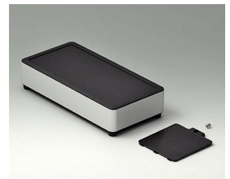
EE183059 SYNERGY E180 Aluminium AlMgSi 0,5 matt eloxiert 180x90x40mm IP 40
