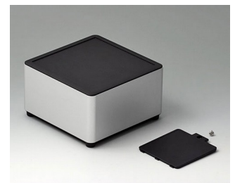
ES126059 SYNERGY S120 Aluminium AIMgSi 0,5 matt eloxiert 120x120x70mm IP 40
