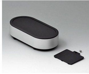
EO163059 SYNERGY O160 Aluminium AlMgSi 0,5 matt eloxiert 160x80x40mm IP 40
