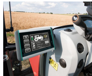
ISOBUS-Terminal für Traktoren und selbstfahrende Arbeitsmaschinen
