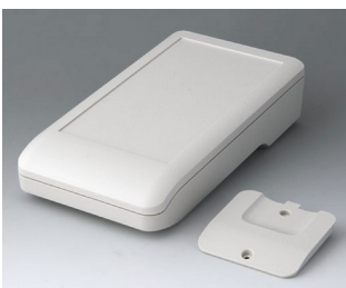
A9007207 DATEC-COMPACT L ASA+PC (UL 94 V-0) grauweiß RAL 9002 206x110x47mm IP 65
