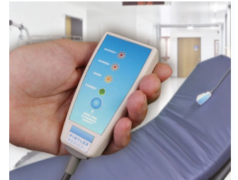
Steuerung von Behandlungsliegen
