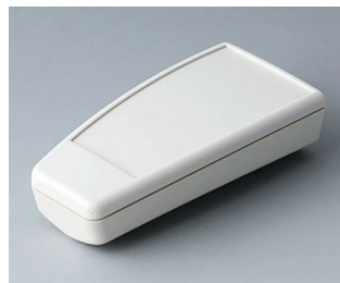
A9066117 SMART-CASE M, Ausf. II ABS (UL 94 HB) grauweiß RAL 9002 96x47x24mm IP 40
