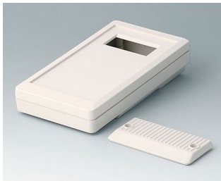
A9073207 DATEC-MOBIL-BOX S, Ausf. II ABS (UL 94 HB) grauweiß RAL 9002 152x83x33,5mm IP 65 opt.
