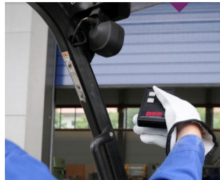
IR-Fernbedienung für raue Umgebung
