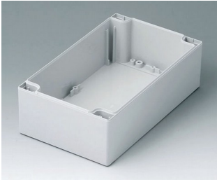
C2122001 Gehäusechale 120, mit Feder ABS (UL 94 HB) lichtgrau RAL 7035 200x120x60mm
