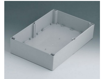
C4243601 Gehäuseschale 240, mit Feder ABS (UL 94 HB) lichtgrau RAL 7035 360x240x80mm
