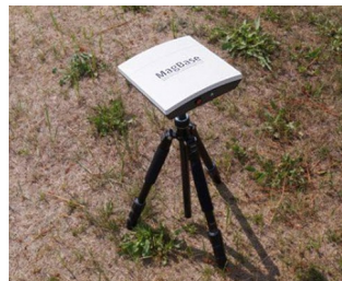
Messstation für stationäre Feldmessungen
