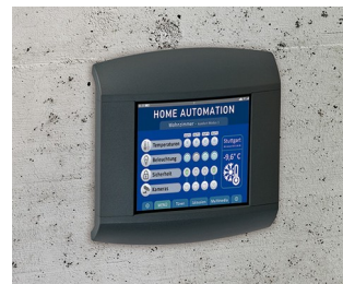
Kontrollpanel für Home Automation
