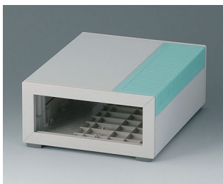
B2213005 MEDITEC E 160, ohne Griffbügel ABS (UL 94 HB) grauweiß RAL 9002 160x200x74mm IP 40
