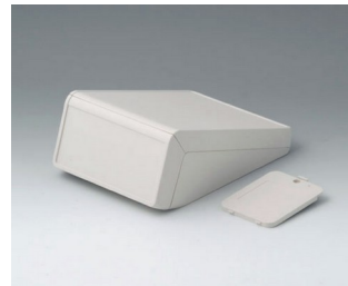
B4054227 UNITEC S, 1,4/0,6 ABS (UL 94 HB) grauweiß RAL 9002 125x177x69mm IP 40
