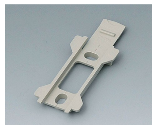
B1340028 Wandhalter für Toptec 102 PC+ABS (UL 94 V-0) kieselgrau RAL 7032
