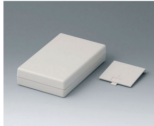
A9408737 SCHALENGEHÄUSE G 155, Ausf. V ABS (UL 94 HB) grauweiß RAL 9002 95x158x33mm
