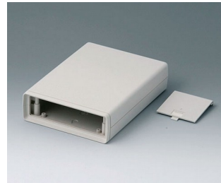
A9413638 SCHALENGEHÄUSE V 190, Ausf. V ABS (UL 94 HB) grauweiß RAL 9002 138x190x45mm
