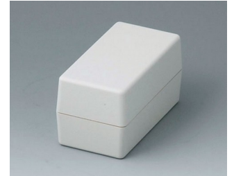
A9404441 SCHALENGEHÄUSE G 85, Ausf. I ABS (UL 94 HB) grauweiß RAL 9002 45x85x45mm IP 65 opt.
