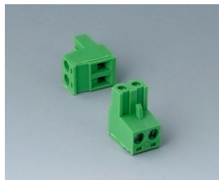
B6606223 Stiftleiste, Raster 5,08 PA 6 (UL 94 V-0)
