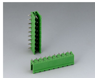
B6602222 Stiftleiste, Raster 5,08 PA 6 (UL 94 V-0)
