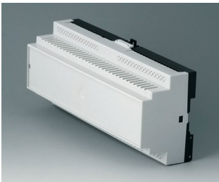
B6506119 RAILTEC B, 12 Module, Ausf. V PC (UL 94 V-0) lichtgrau RAL 7035 210x90x58mm
