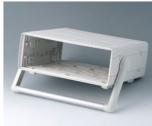
A0224670 EUROPA-GEHÄUSE 42 TE, m. Griffb. ABS (UL 94 HB) grauweiß RAL 9002 260x250x98,5mm
