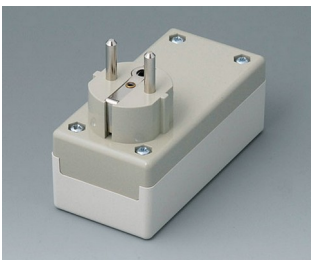
A9011665 STECKERGEHÄUSE F / D, Ausf. I PC+ABS (UL 94 V-0) grauweiß RAL 9002 100x50x40mm
