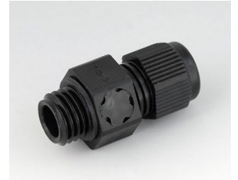
C2312919 Kabelverschraubung M12x1,5, mit Integriertem Druckausgleich PA schwarz RAL 9005 IP 68
