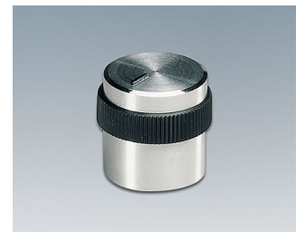
A1416449 DREHKNOPF, mit seittl. Schraubbefestigung ABS (UL 94 HB) glänzend 15,9x15mm 4mm
