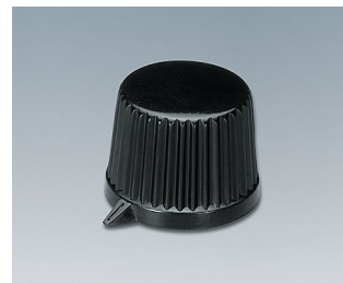
A1613560 DREHKNOPF, mit seittl. Schraubbefestigung ABS (UL 94 HB) schwarz RAL 9005 19,9x15,5mm 6mm
