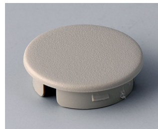
A4123007 Deckel 23, ohne Strich ABS (UL 94 HB) kieselgrau RAL 7032
