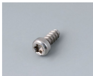
A0325060 Selbstformende Schraube 2,5 x 6 mm (T8) Edelstahl
