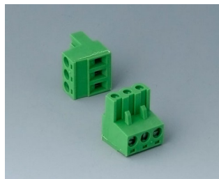
B6600223 Stiftleiste, Raster 5,08 PA 68 (UL 94 V-0)
