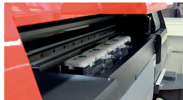
Digitale Bedruckung von Gehäusen
