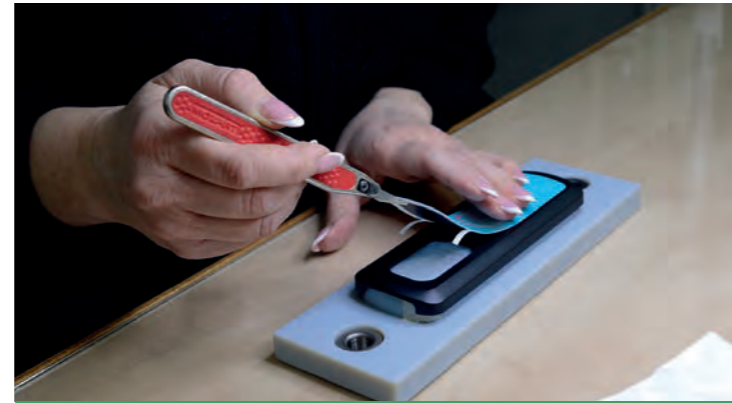
Einkleben der Frontfolie ins Gehäuse
