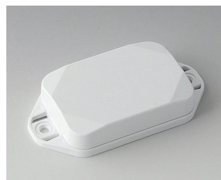
B1822127 MINI-DATA-BOX EF40, plate avec bride ASA+PC (UL 94 V-0) blanc signalisation RAL 9016 60x40x15mm IP 65 opt., IP 40
