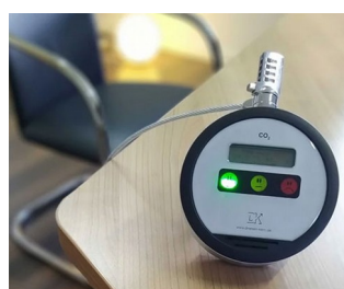
Feu de signalisation CO2
