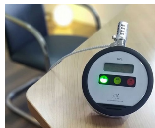
Feu de signalisation CO2
