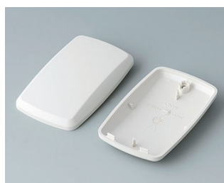
B9004857 Partie inférieure et supérieure EM ABS (UL 94 HB) gris blanc RAL 9002 68x42x18mm
