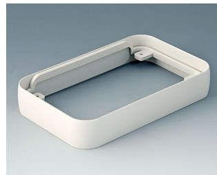
A9152017 Bague intermédiaire L ABS (UL 94 HB) gris blanc RAL 9002 76x120x21mm
