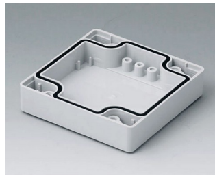
C0080802 Coquille 80, avec joint PC (UL 94 HB) gris clair RAL 7035 80x80x20mm
