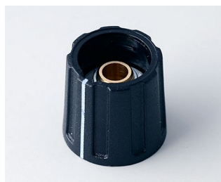
A2616060 BOUTON ROND 16, avec trait ABS (UL 94 HB) noir RAL 9005 16x15mm 6mm
