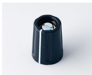
A2610040 BOUTON ROND 10, avec trait ABS (UL 94 HB) noir RAL 9005 10x14mm 4mm
