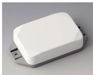
B1824226 MINI-DATA-BOX EF50, высокий, с ушками АСА+ПК (UL 94 V-0) белый RAL 9016 70x50x20mm IP 65 opt., IP 40
