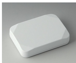
B1824117 MINI-DATA-BOX E50, плоский АСА+ПК (UL 94 V-0) белый RAL 9016 70x50x15mm IP 65 opt., IP 40
