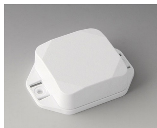
V1804227 MINI-DATA-BOX SF50, высокий, с ушками АСА+ПК (UL 94 V-0) белый RAL 9016 50x50x20mm IP 65 opt., IP 40
