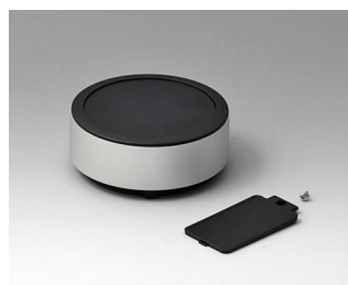
ER103059 SYNERGY R100 Алюминий AlMgSi 0,5 матово-анодированный ø100x40mm IP 40
