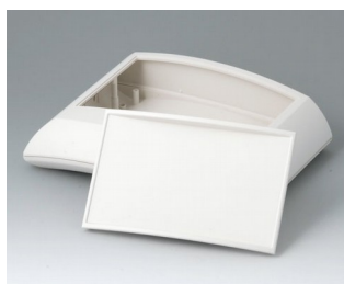
B7020137 ERGO-CASE L, плоский АБС (UL 94 HB) белый RAL 9002 150x200x54mm IP 40
