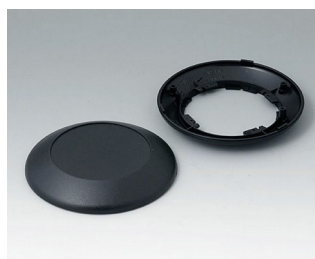
B5010009 Нижняя и верхняя части R110 F АБС (UL 94 HB) черный RAL 9005 ø110x30mm
