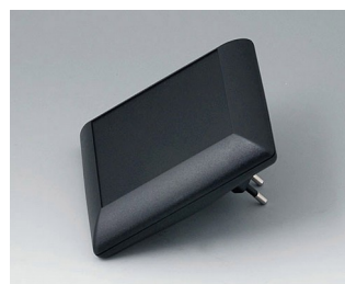
B5013229 ART-CASE S110 F (с вилкой) ПК+АБС (UL 94 V-0) черный RAL 9005 110x110x38mm IP 40
