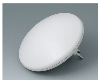
B5011327 ART-CASE R110 H (с вилкой) ПК+АБС (UL 94 V-0) белый RAL 9002 ø110x41mm IP 40
