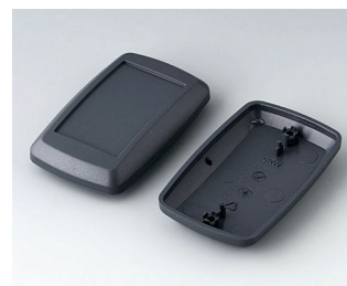
B9006818 Верхняя и нижняя части EL АБС (UL 94 HB) лава 78x48x24mm
