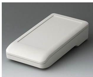
A9006107 DATEC-COMPACT M АСА+ПК (UL 94 V-0) белый RAL 9002 172x92x39mm IP 65
