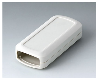
B2823107 CONNECT S ACA+ПК (UL 94 V-0) белый RAL 9002 90x42x22mm
