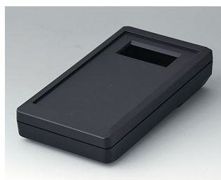
A9073409 DATEC-MOBIL-BOX S, исп. IV АБС (UL 94 HB) черный RAL 9005 152x83x33,5mm IP 65 opt.
