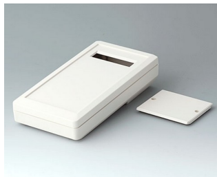
A9074307 DATEC-MOBIL-BOX M, исп. III АБС (UL 94 HB) белый RAL 9002 195x101x44mm IP 65 opt.
