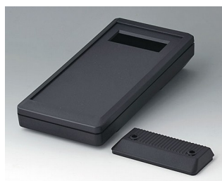
A9075209 DATEC-MOBIL-BOX L, исп. II АБС (UL 94 HB) черный RAL 9005 252x121x50mm IP 65 opt.
