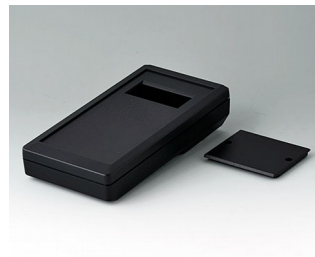
A9074409 DATEC-MOBIL-BOX M, исп. IV АБС (UL 94 HB) черный RAL 9005 195x101x44mm IP 65 opt.
