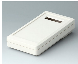
A9073317 DATEC-MOBIL-BOX S, исп. III АБС (UL 94 HB) белый RAL 9002 152x83x33,5mm IP 65 opt.
