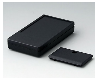
A9071219 DATEC-POCKET-BOX M ПММА (ИК) (UL 94 HB) черный RAL 9005 105x58x18,5mm IP 54
