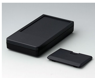
A9072229 DATEC-POCKET-BOX L ПММА (ИК) (UL 94 HB) черный RAL 9005 120x65x22mm IP 41
