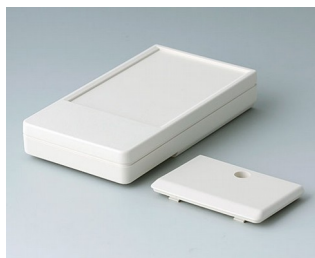
A9071117 DATEC-POCKET-BOX M АБС (UL 94 HB) белый RAL 9002 105x58x18,5mm IP 54
