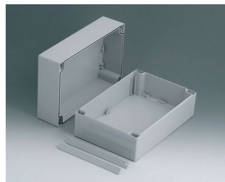
C2416241 ROBUST-BOX с шириной 160, исп. I АБС (UL 94 HB) светло-серый RAL 7035 240x160x120mm IP 66
