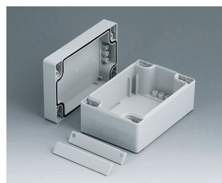
C2008122 ROBUST-BOX с шириной 80, исп. II ПК (UL 94 HB) светло-серый RAL 7035 120x80x60mm IP 66
