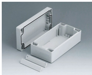
C2008161 ROBUST-BOX с шириной 80, исп. I АБС (UL 94 HB) светло-серый RAL 7035 160x80x60mm IP 66
