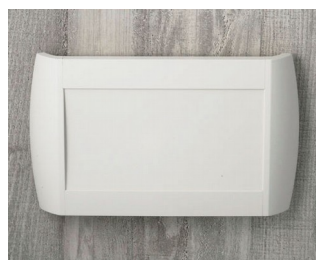
A9095107 DIATEC L АБС (UL 94 HB) белый RAL 9002 330x48x200mm IP 40
