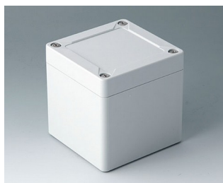
C7008021 IN-BOX АБС (UL 94 HB) светло-серый RAL 7035 84x82x85mm IP 66, IP 67, IK 07
