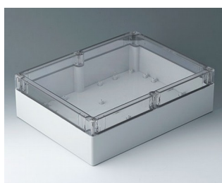
C7030104 IN-BOX АБС/ПК (UL 94 HB) светло-серый RAL 7035 302x232x90mm IP 66, IP 67, IK 07
