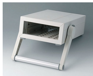
B2212117 MEDITEC E 220, с ручкой АБС (UL 94 HB) белый RAL 9002 160x260x74mm IP 40
