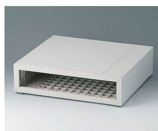
B2210017 MEDITEC D 220, без ручки АБС (UL 94 HB) белый RAL 9002 290x260x74mm IP 40
