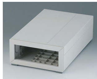
B2212017 MEDITEC E 220, без ручки ABC (UL 94 HB) белый RAL 9002 160x260x74mm IP 40
