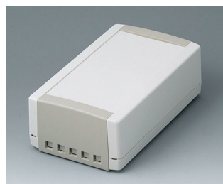
B1070465 TOPTEC 194 H, исп. II АБС (UL 94 HB) белый RAL 9002 194x115x68mm IP 40
