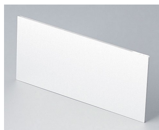
B6132111 Лицевая панель Алюминий матово-анодированный 91,5x43,4x1,5mm
