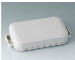
C3207107 EASYTEC 125 ACA+ПК (UL 94 V-0) белый RAL 9002 147x78x30mm IP 65 opt., IP 40
