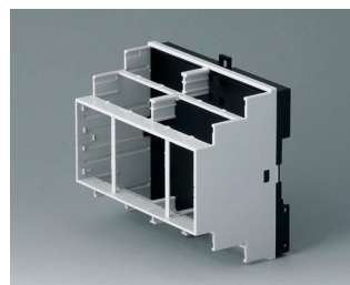
B6504121 RAILTEC B, 6 модулей, исп. VI ПК (UL 94 V-0) светло-серый RAL 7035 105x90x58mm
