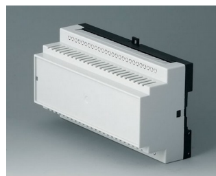
B6505119 RAILTEC B, 9 модулей, исп. V ПК (UL 94 V-0) светло-серый RAL 7035 157x86x59mm
