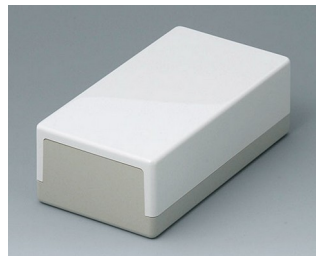
A9020065 FLAT-PACK CASE 120 N, исп. I АБС (UL 94 HB) белый RAL 9002 120x65x40mm IP 40
