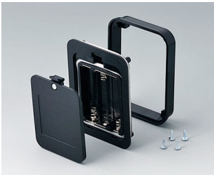
A9336119 Батарейный отсек, 3 x AA АБС (UL 94 HB) черный RAL 9005 93x69mm IP 54
